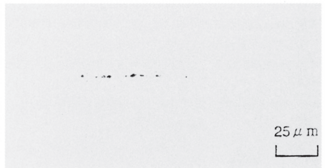
図6 従来材に観察されるB系介在物例
